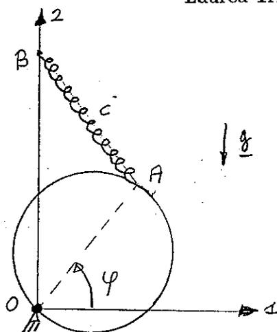
È dato un disco omogeneo di raggio  $R$  e massa  $M$ , vincolato in un piano verticale come in figura, cerniera fissa in  $O$  e forza elastica in  $A$  di costante  $c$ ,  $\overline{OA} = 2R$ ,  $\overline{OB} = 6R$ , vincoli lisci. Il disco è soggetto al proprio peso e alla forza elastica in  $A$ .
