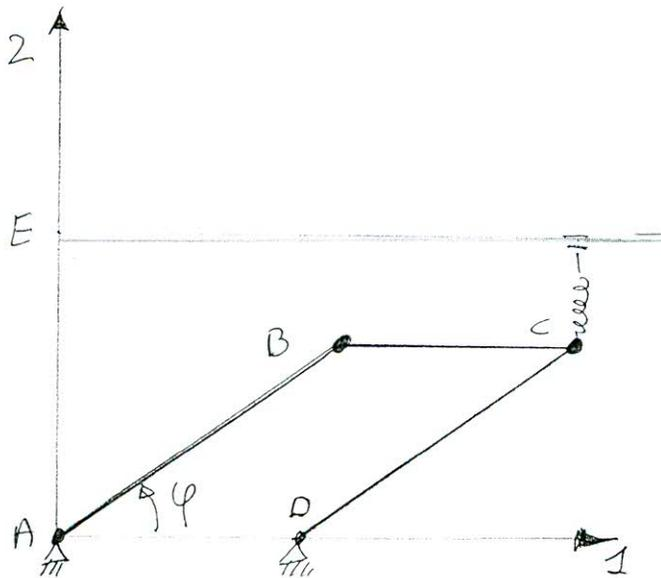
È data la struttura articolata di figura, costituita da tre aste, ciascuna omogenea, vincolata in un piano orizzontale, vincoli lisci. La struttura è soggetta a una forza elastica in  $C$  di costante elastica  $c$ .
