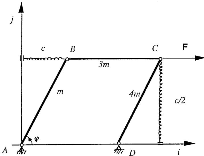
È data la struttura articolata di figura, costituita da tre aste di uguale lunghezza  $l$ , poste nel piano orizzontale e vincolate con vincoli lisci. Essa è soggetta alla sollecitazione di una molla in  $B$  e di una in  $C$  e di una forza costante  $F$  in  $C$ .
