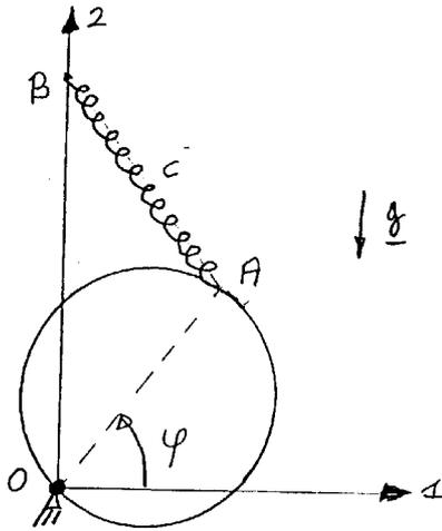
È dato un disco omogeneo di raggio  $R$  e massa  $M$ , vincolato in un piano verticale come in figura, cerniera fissa in  $O$  e forza elastica in  $A$  di costante  $c$ ,  $\overline{OA} = 2R$ ,  $\overline{OB} = 3R$ , vincoli lisci. Il disco è soggetto al proprio peso e alla forza elastica in  $A$ .
