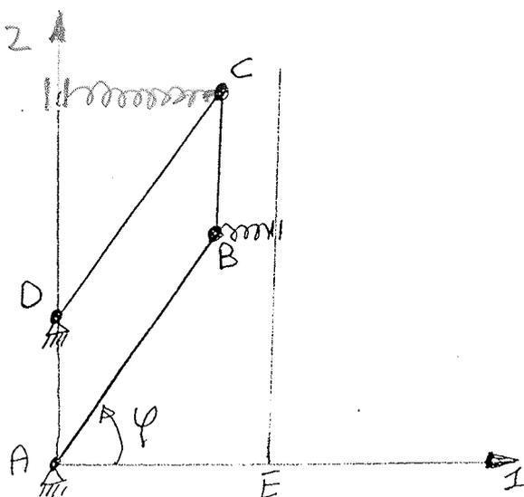
È data la struttura articolata di figura, costituita da tre aste, ciascuna omogenea, vincolata in un piano orizzontale, vincoli lisci. La struttura è soggetta a una forza elastica in  $B$  di costante elastica  $c$  e a una forza elastica in  $C$  di costante elastica  $c$ .
